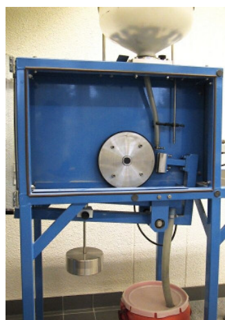
Abbildung 1: Einrichtung für Abriebversuche mit Trockensand und rotierendem Gummirad.
